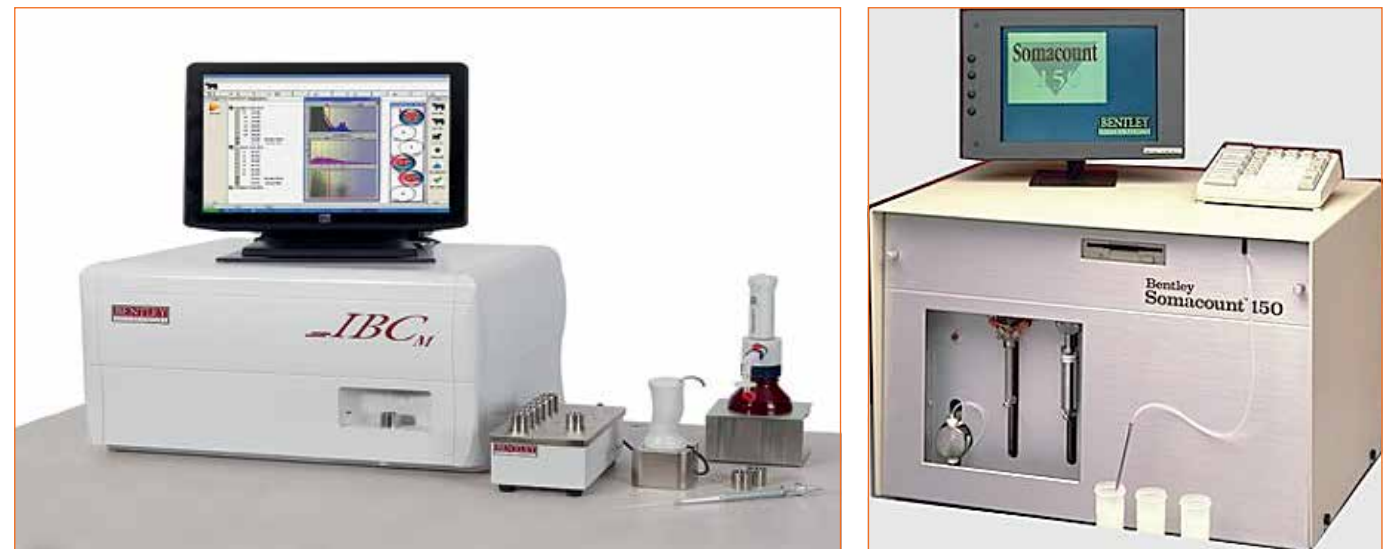
Figura 179 – Aparatul: BentleyIBC, numărator de bacterii: 50–150 probe/oră (stânga); SomacountTM 150–300–500 probe/oră (dreapta), instrument de mare precizie pentru determinarea celulelor somatice din lapte (dreapta)
