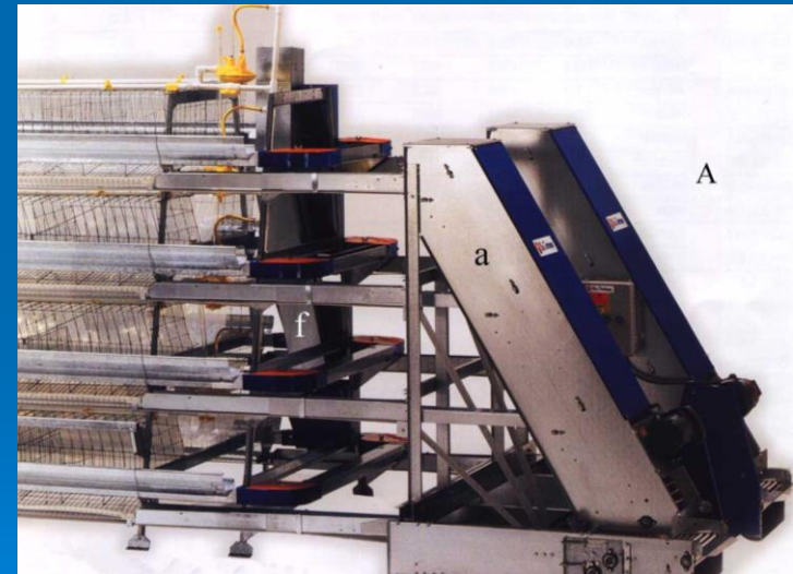
Baterie de cuști de tip piramidal pe patru nivele, neecologică a. Cap de acționare a jgheabului de furajare; f. Sistem furajare în cascadă
