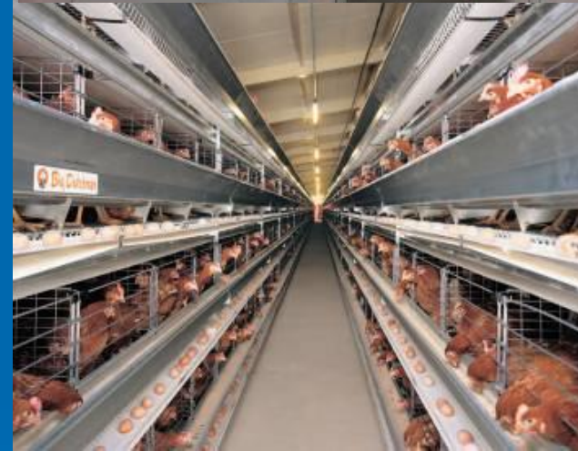
Baterii de cuști verticale, ecologice Sus: sistemul de uscare a dejecțiilor pe banda colectoare și sistemul de alimentare cu furaj în cascadă)
