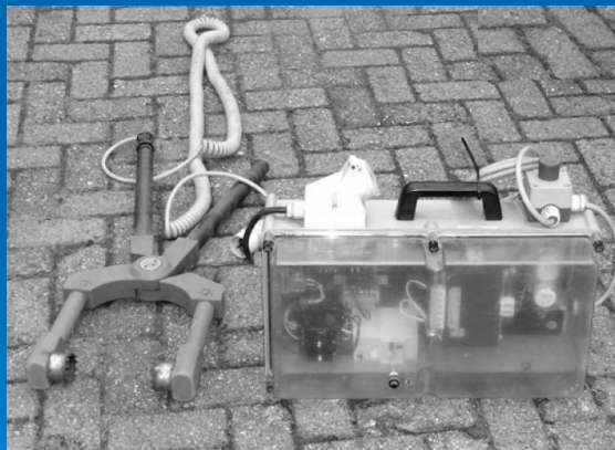
Asomator cu electrozi de tip clește
