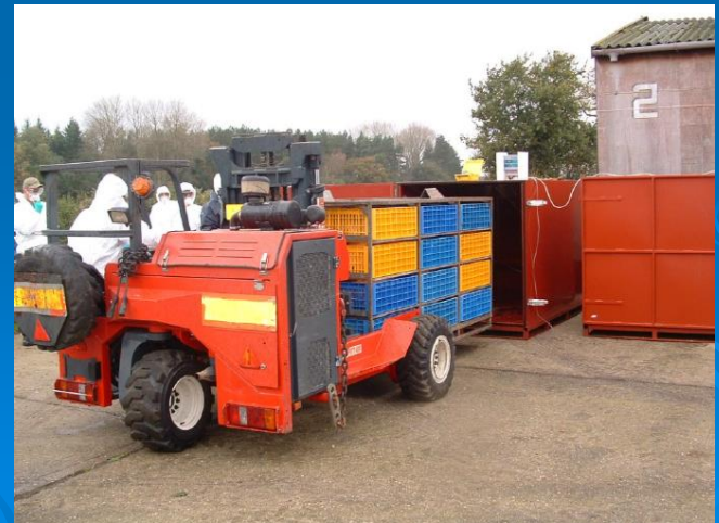
Unitate containerizată de gazare pentru găini – tăieri de necesitate (OIE, 2011)
